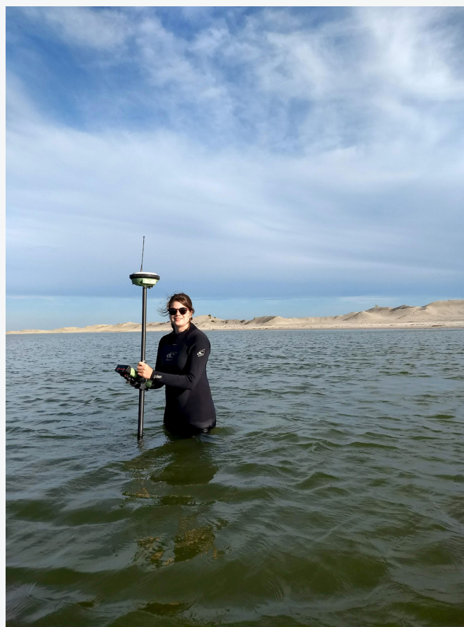
PhD Anne Ton (TU Delft) bezig met het uitvoeren van bodemhoogte metingen op de zandige oevers van de MarkerWadden
