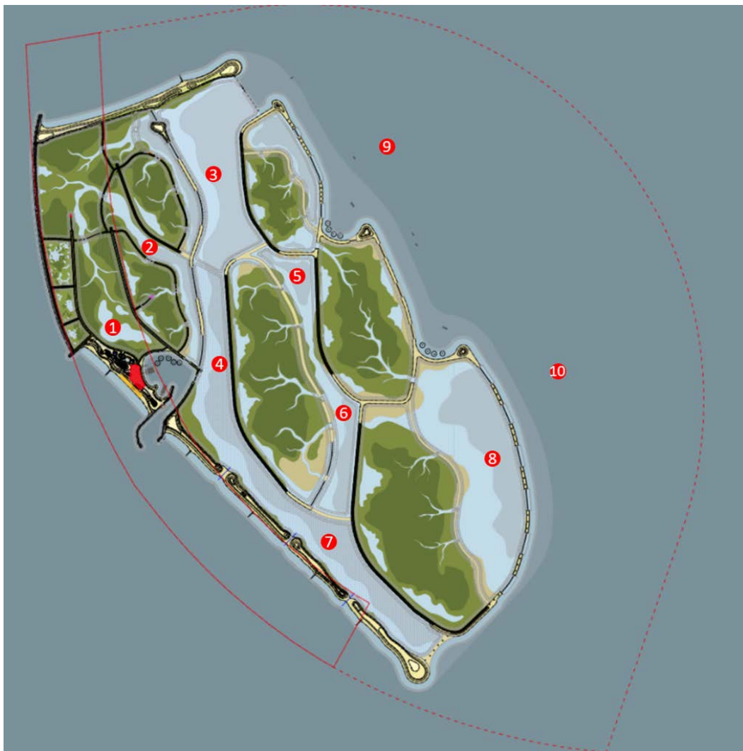
Figuur 8. Voorstel voor een netwerk van locaties met mini-meetpalen voor continumetingen van waterhoogte, lichtinval en watertemperatuur.
