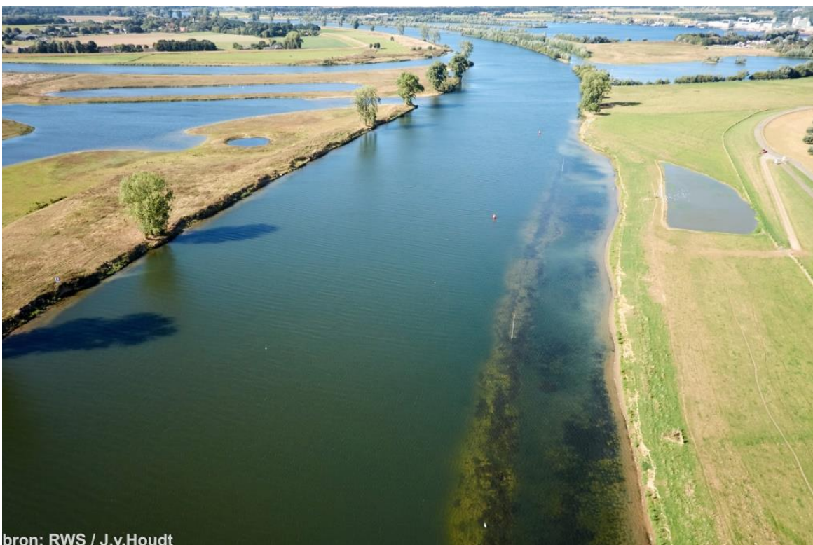
Figuur 3.62 De afgegraven oeverzone bij Balgoy is duidelijk zichtbaar. Rechts ligt de ondiepe pool. Aan de lichtbruine pluim is te herkennen dat hier nog steeds erosie plaats vindt.
