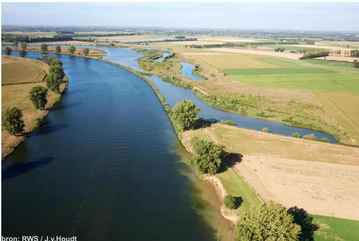
Figuur 3.72 Luchtfoto van de Batenburgse Maasarm en de smalle breuksteendam die de nieuw gegraven oevergeul afscheidt van de Maas. Rechts is het meest benedenstroomse traject van de Niftrikse Waarden herkenbaar.
