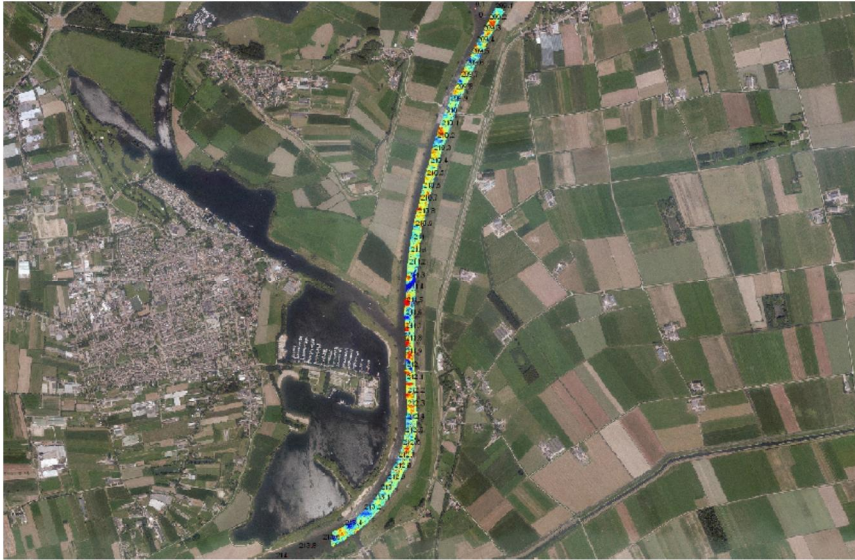
Figuur 3.62 (Boven) Luchtfoto met diepte verschilkaart van De Paaldere – Het Wildt. Blauw = erosie; Rood = sedimentatie. (Onder) Luchtfoto met diepte verschilkaart van de rechter oever van waarbij ook de locatie Maren zichtbaar is.
