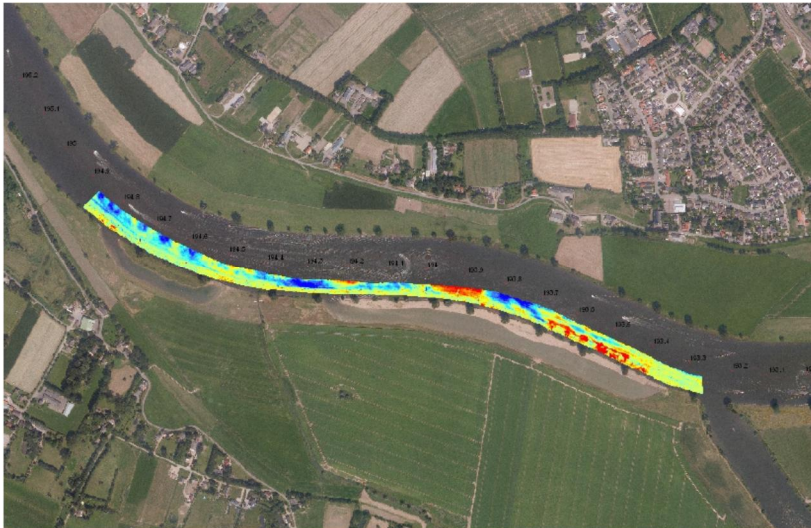
Figuur 3.48 Luchtfoto met diepte verschillen van Ossekamp. Blauw = erosie; Rood = sedimentatie.
