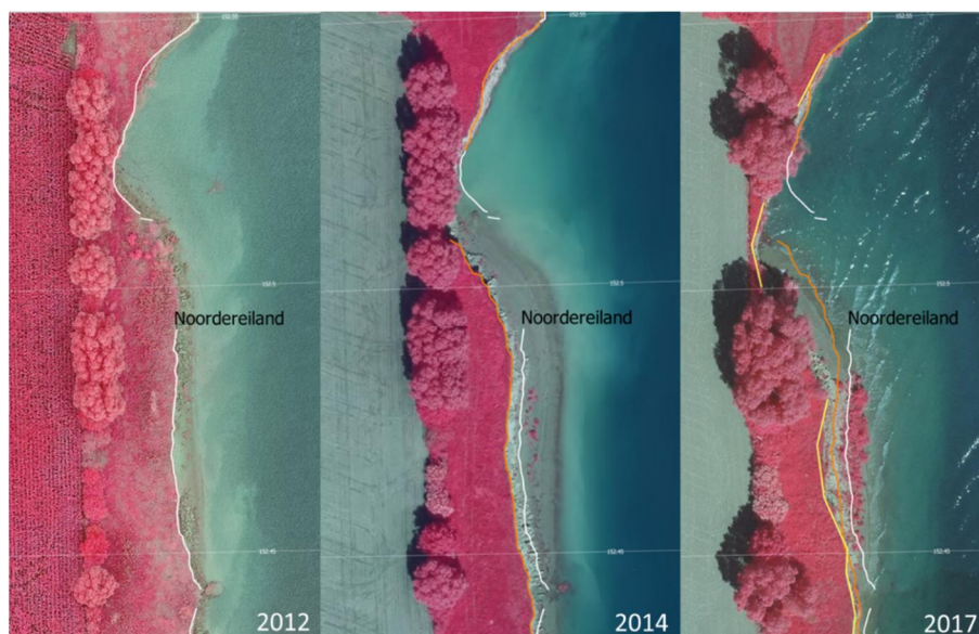
Figuur 7.2 Luchtfotointerpretatie voor 2012, 2014 en 2017 op locatie Noordereiland tussen rivkm 154.45 en 152.55. Lijnen wit (2012), oranje (2014) en geel (2017) beschrijven de steilwanden. De steilwanden zijn niet altijd consequent doorgetrokken. Vegetatie zoals bomen (zie 2017) belemmert de steilwandregistratie.
